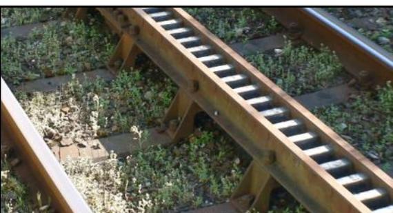
Bei Zahnradbahnen kommen je nach Anwendungsfall unterschiedliche Zahnschienensysteme zum Einsatz. Sie werden je nach Steigung, Traglast, Kurvenradien, Notwendigkeit von Weichen oder niveaugleichen Bahnübergängen ausgewählt. Es gibt auch Bahnen, die nur auf den steileren Teilen der Strecke im Zahnradbetrieb fahren.
